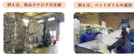
効率よく運搬・リサイクルできるよう、専用の機械で種類ごとに大きな束にまとめます。商品カタログの束は一つ約1.1トン！
